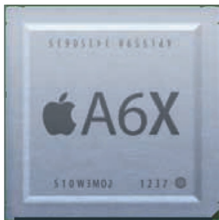
Applova implementacija arhitekture ARMv7 (Apple Swift) v kombinaciji s trenutno najmočnejšim grafičnim procesorjem - PowerVR SGX554MP4.
