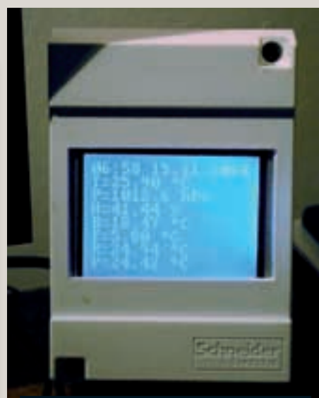
Doma narejen prikazovalnik GLCD z zaslonom na dotik, lastnim mikrokrmilnikom, ki prikazuje podatke z vremenske postaje v ohišju, sicer namenjenem za avtomatske omrežne odklopnike
