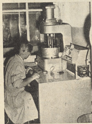
▲ Na tem aparatu ugotavljamo plastičnost po Mooneyju in začetek vulkanizacije
