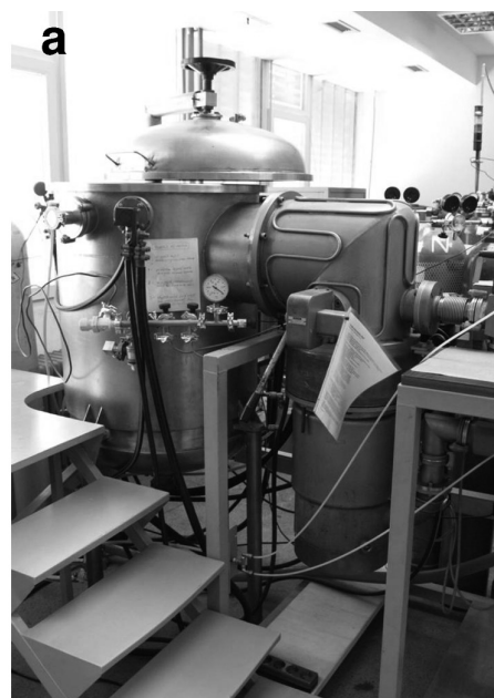
Slika 11: Eksperimentalna visokovakuumska peč s premičnim zunanjim grelnikom (kar omogoča hitro ohlajanje) in z inštalacijami za vpust različnih plinov
