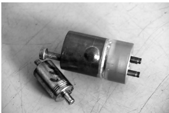
Slika 5: Primer materiala, ki za spajkanje v vakuumu ni primeren. V kosu bakra, ki je vseboval nekaj kisika (nad pribl. 0,04 %), je v vodikovi atmosferi vodik reagiral s kisikom. Nastala je vodna para, ki je med kristali ekspandirala; struktura v notranjosti je razpokala in navzven povzročila bulo (premer bule je 6 mm).
