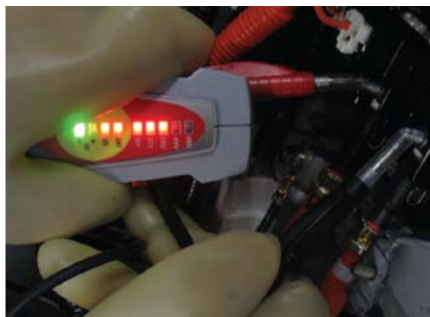
Slika 4: Preizkušanje breznapetostnega stanja
