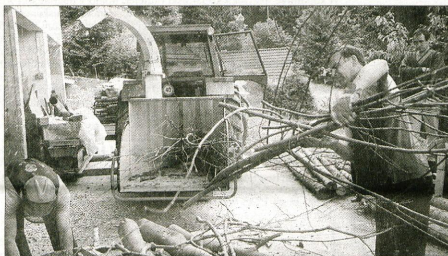
Priprava lesnih sekancev s pomočjo traktorskega sekalnika.
