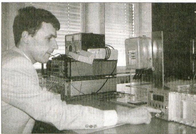
S pomočjo daljinskega odčitavanja pridejo iz papirnice Goričane vsakih petnajst minut podatki v Elektro Gorenjske.
