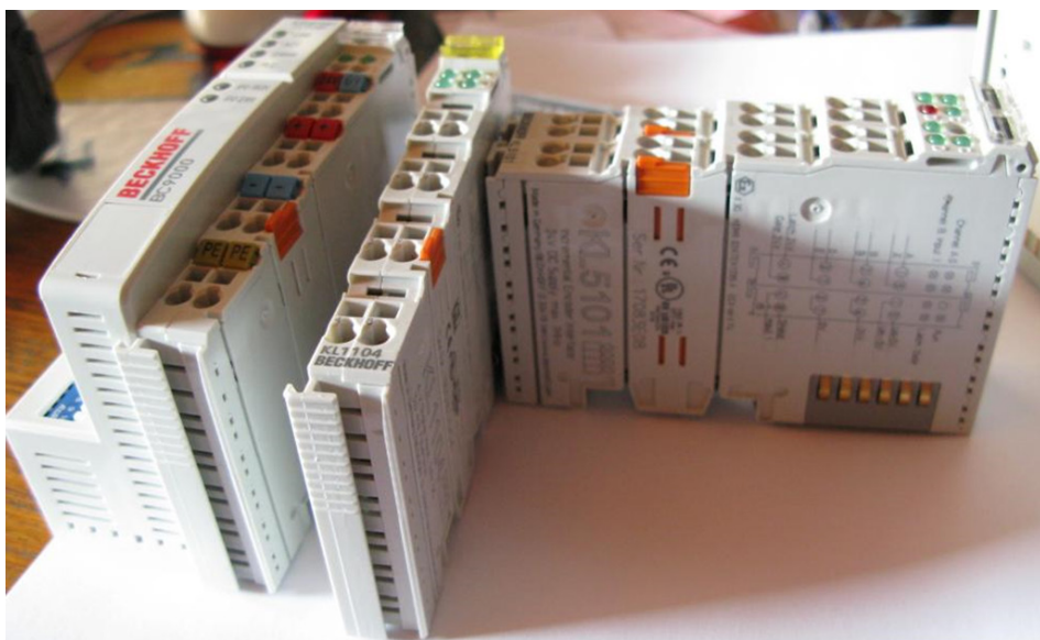
Slika 4: Programabilni modularno grajen logični krmilnik Beckhoff®
