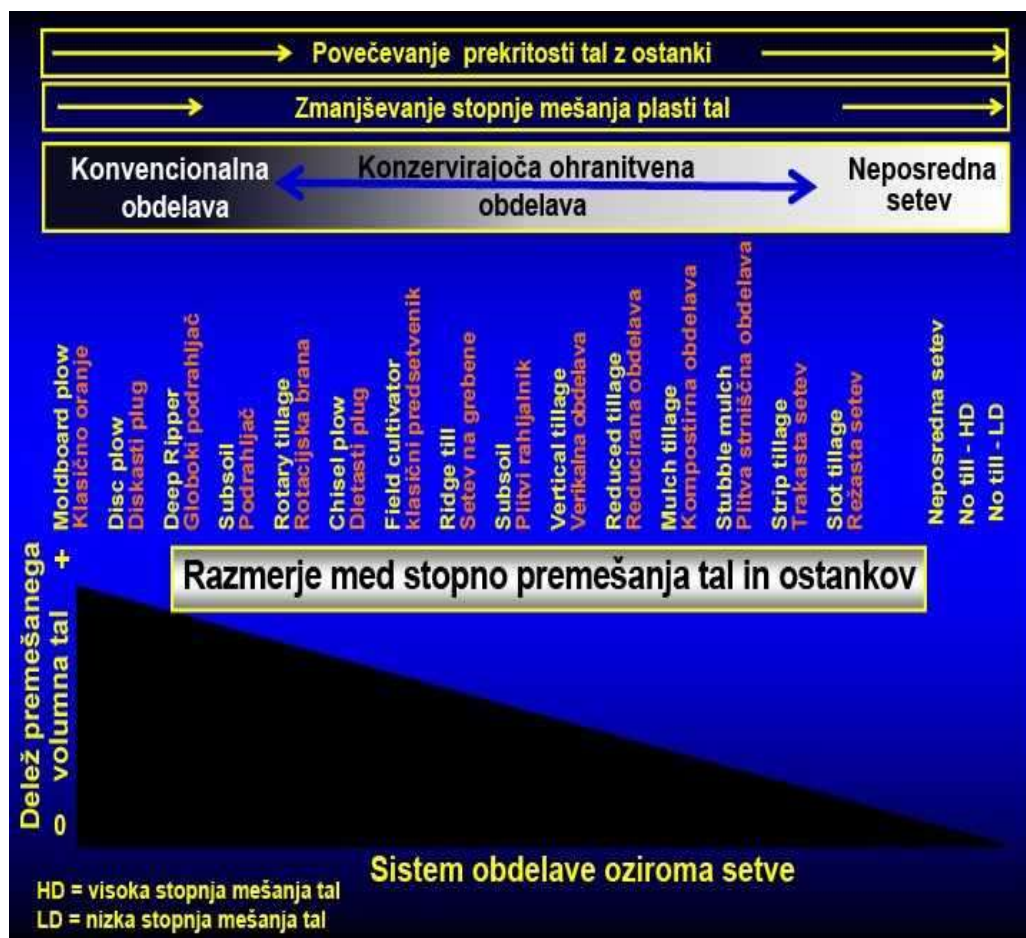
Slika 30: Primerjava različnih orodij in sistemov obdelave glede na stopnjo mešanja tal in prekritosti površja tal z ostanki (povzeto po Reicosky; http://www.soilcc.ca/soilsummit/2017/presenters/1-don-reicosky.pdf ).
