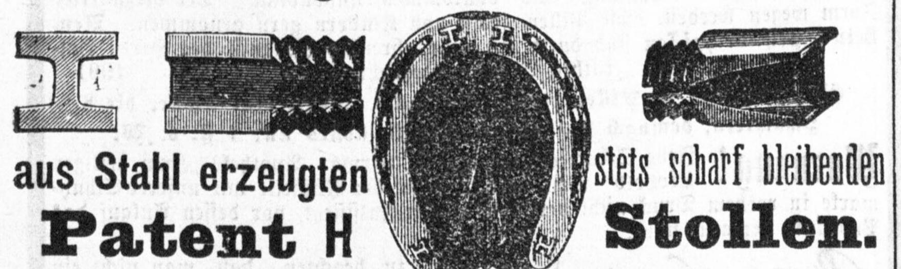
Da dieselben auch als Griffe zu verwenden sind, kann das Schärfen des Hufbeschlages durch bloßes Einschrauben der Patent-Stollen ermöglicht werden, ohne dass es nöthig ist, die Hufeisen von den Hufen der Pferde zu entfernen, was anderseits für die Schonung des Hufes von größter Wichtigkeit ist.
