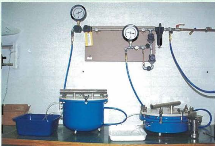
Slika 6: Richardovi aparaturi za določevanje vodno-zračnih lastnosti tal (foto: M. Urbančič)
