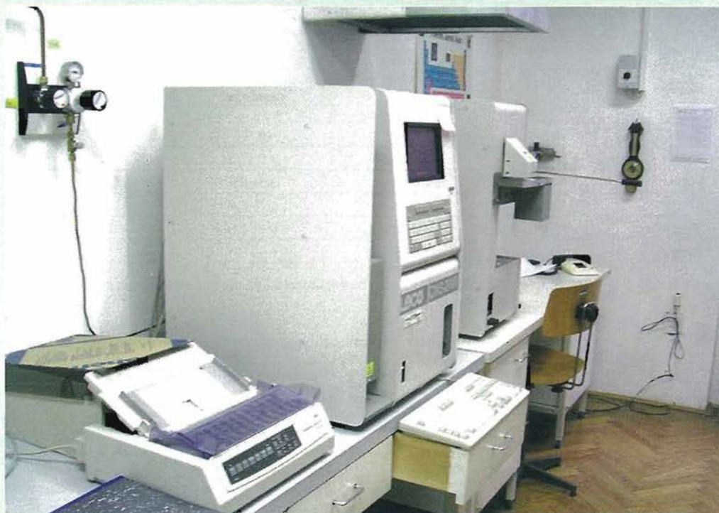
Slika 7: Elementni analizator ogljika, dušika in žvepla Leco CNS-2000 (foto: Daniel Žlindra)
