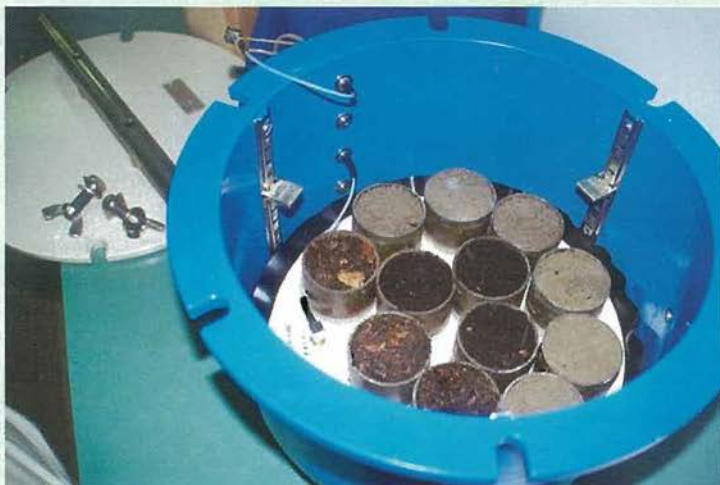
Slika 5: Talni vzorci na keramični plošči Richardovega tlačnega eksikatorja (foto: M. Urbančič)
