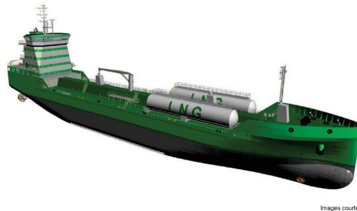
Fig. 2. Hull-independent tank on an LNG carrier [4]
