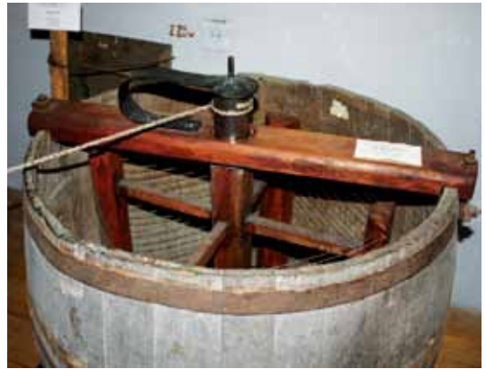
Zanimiva izvedba točila. S potegom vrvice se točilo zasuka. Z vrtenjem točila se vrvica navije nazaj za nov poteg.
