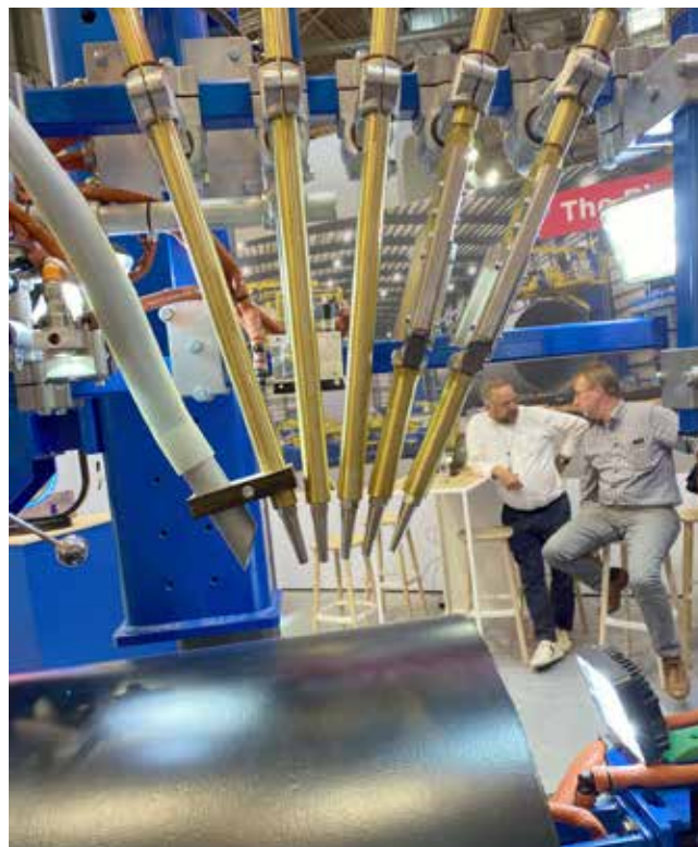
Slika 2: Varjenje pod praškom s petimi varilnimi žicami
