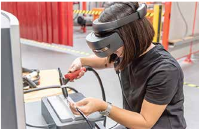
Slika 3: Simulator za učenje varjenja po postopku TIG
