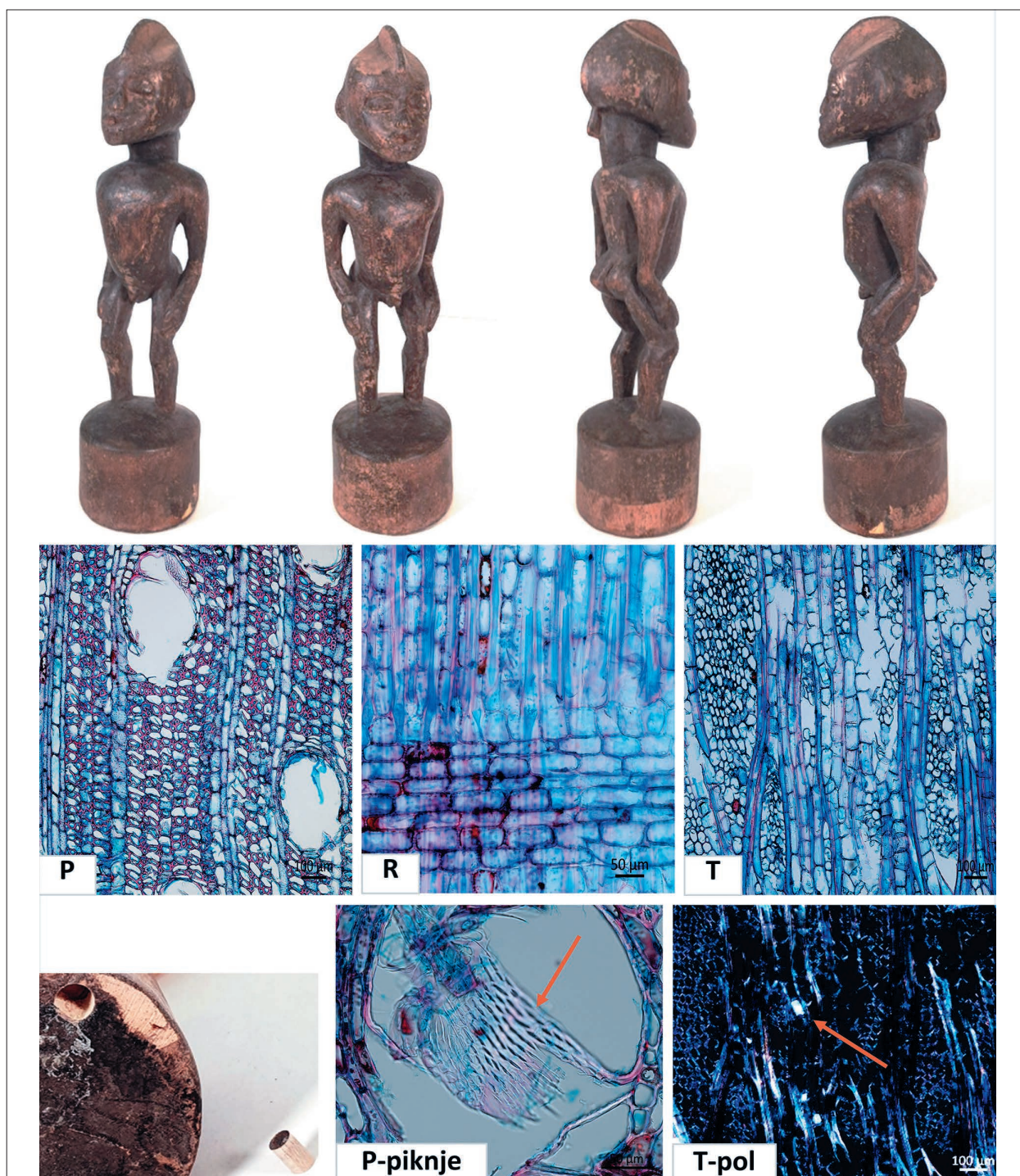
Slika 7. Kipek P40 v različnih pogledih (zgoraj), mikro izvrtek, odvzet iz spodnjega dela kipca (spodaj levo), ter mikroskopska zgradba lesa v različnih pogledih v presevni svetlobi (P – prečni, R – radialni, T – tangencialni prerez) in polarizirani svetlobi (P-pol, R-pol, T-pol). Puščice: piknje v prečnem prerezu in kristali v trakovnem parenhimu.
