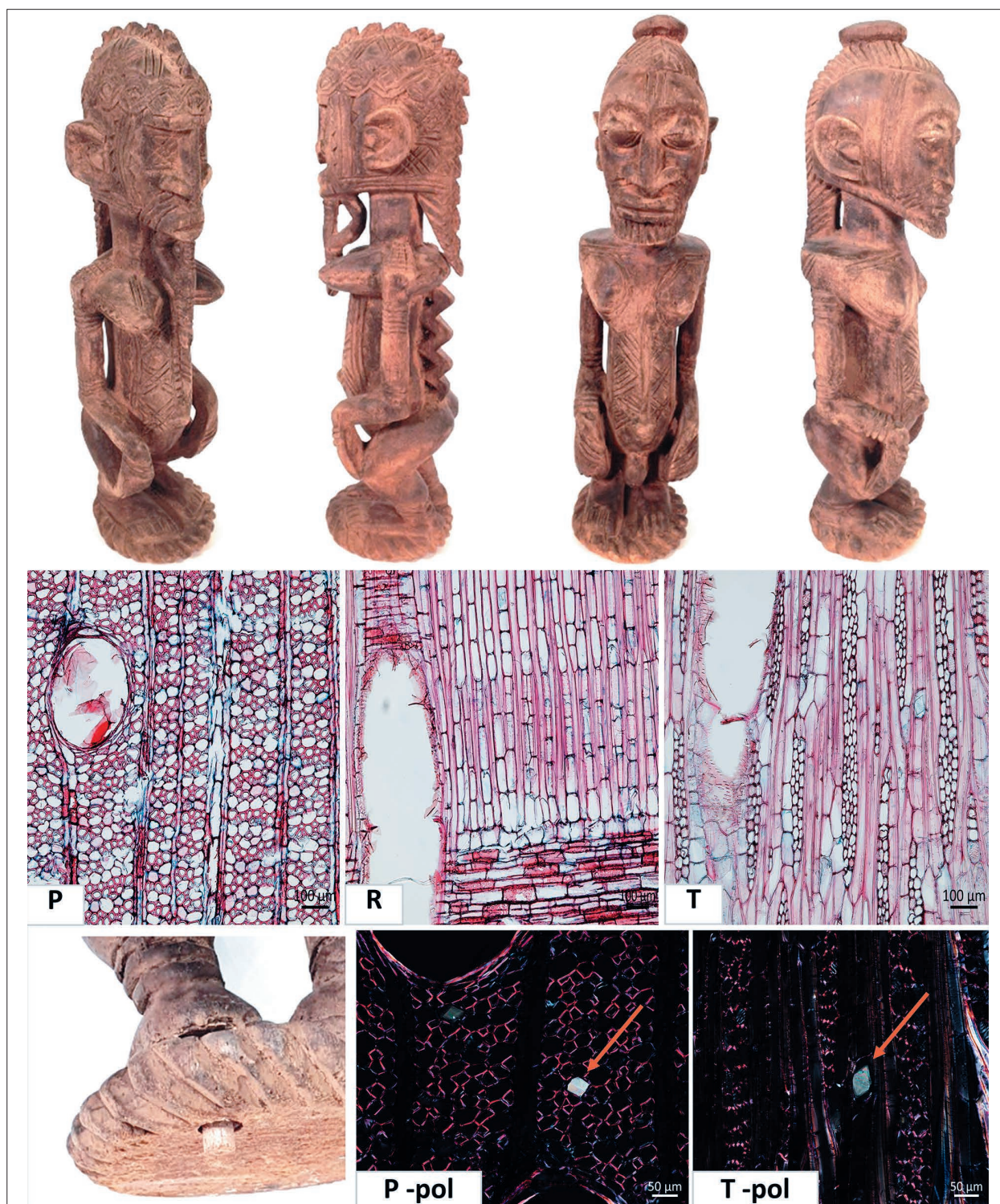
Slika 10. Kipec VZ1 in VZ2 v različnih pogledih (zgoraj), mikro izvrtek odvzet iz spodnjega dela kipca (spodaj levo), ter mikroskopska zgradba lesa v različnih pogledih v presečni svetlobi (P – prečni, R – radialni, T – tangencialni prerez) in polarizirani svetlobi (P-pol, R-pol, T-pol). Puščice: kristali v trakovnem parenhimu.
