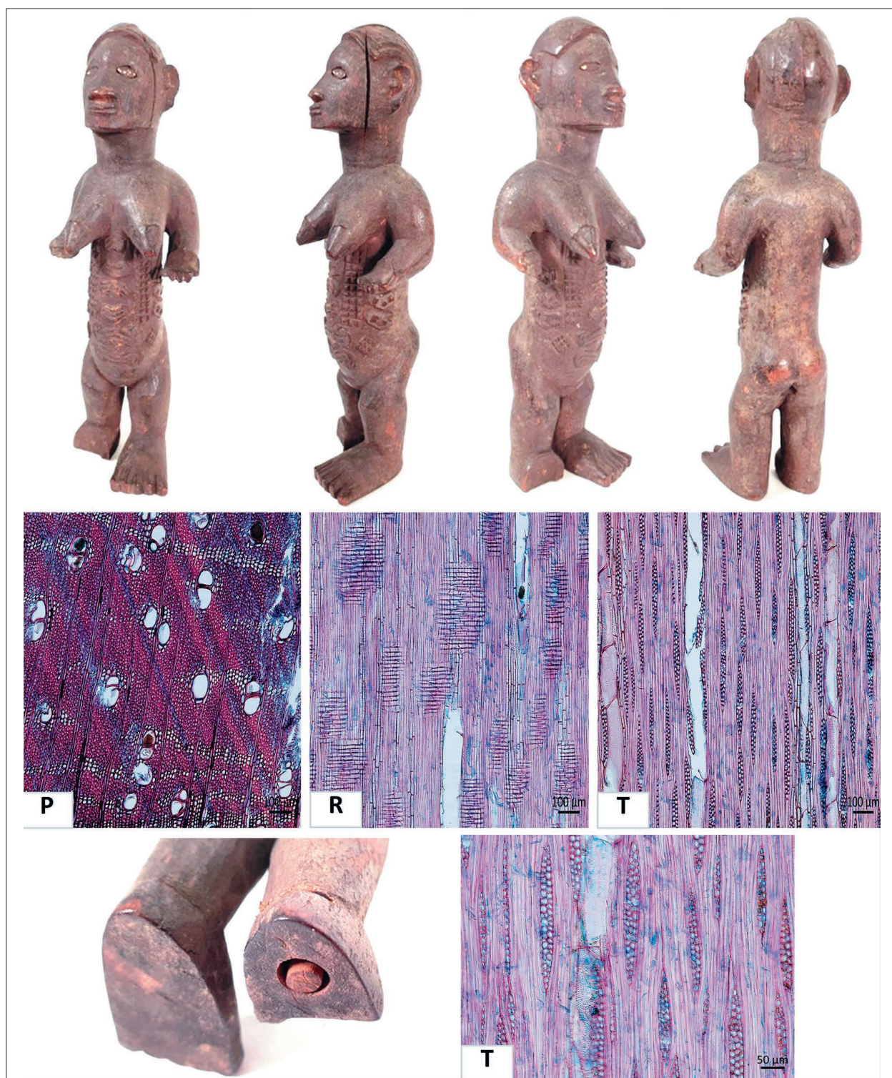
Slika 12. Kipec VZ3 v različnih pogledih (zgoraj), mikro izvrtek odvzet iz spodnjega dela kipca (spodaj levo), ter mikroskopska zgradba lesa v različnih pogledih v presečni svetlobi (P–prečni, R–radialni, T–tangencialni prerez).
