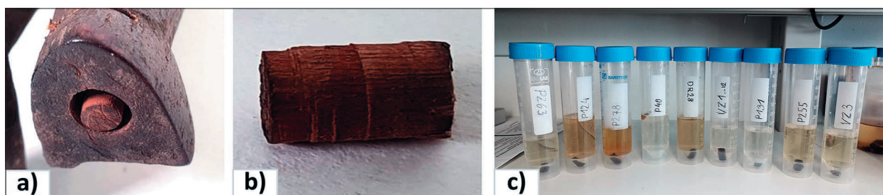
Slika 3. Odvzem in priprava vzorcev: a) prikaz lokacije odvzema, b) vzorec v obliki izvrtka (7 mm × 15 mm), c) vzorci v mehčalnem mediju.
