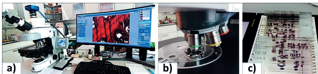
Slika 5. Mikroskopska identifikacija lesa: a) mikroskop Axio Imager (Zeiss GmbH) in program Zen 3.3 Blue Edition (Zen Pro; Zeiss GmbH), b) vzorec, vpet v vrtljiv nosilec na mikroskopu, c) trajni mikroskopski preparati.
