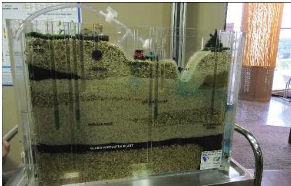
Slika 2: Demonstracijski model za pretakanja vode skozi geološke plasti, ki so ga izdelali na Geološkem zavodu Slovenije.
