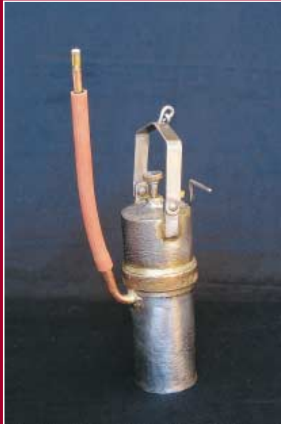
Kotlarska svetilka za preverjanje stanja notranjosti kotla parne lokomotive
