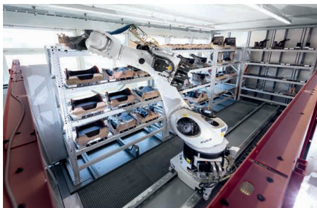
» Robotski sistem RS 3 z dodatno linearno osjo za skupno 43 palet z obdelovanci
