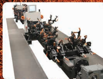
Varilna robotska celica s H-vrtljivo mizo in dvoosnim pozicionerjem
