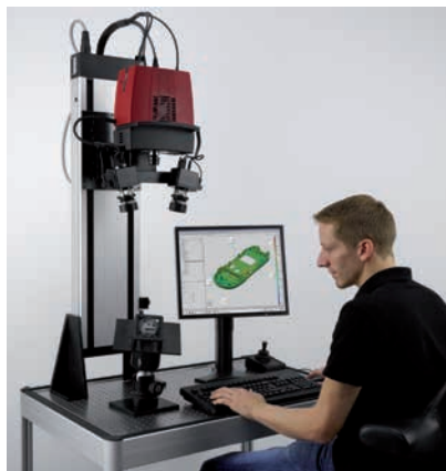
» Slika 1: Digitalizacija malih delov s sistemom ATOS 50
