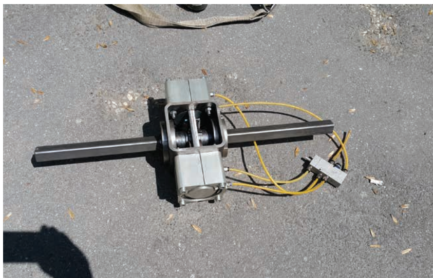
» Slika 6: Inovativni pnevmatični pogon avtomobilske prikolice na kmetijskih površinah
