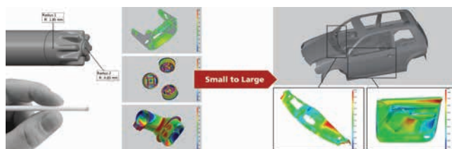
» Slika 9: Prikaz malega zobnika krmila in kotnega adapterja ter njihovih odstopanj od ustreznih nominalnih podatkov (CAD-podatkov), merilni volumen 30 x 20 mm
