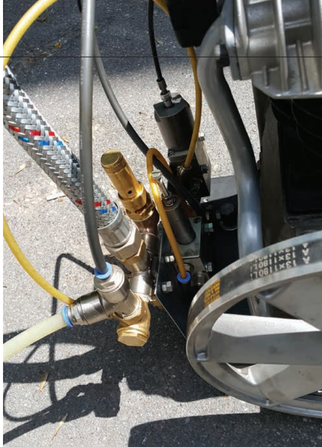
» Slika 3: Lastna regulacija kompresorja
