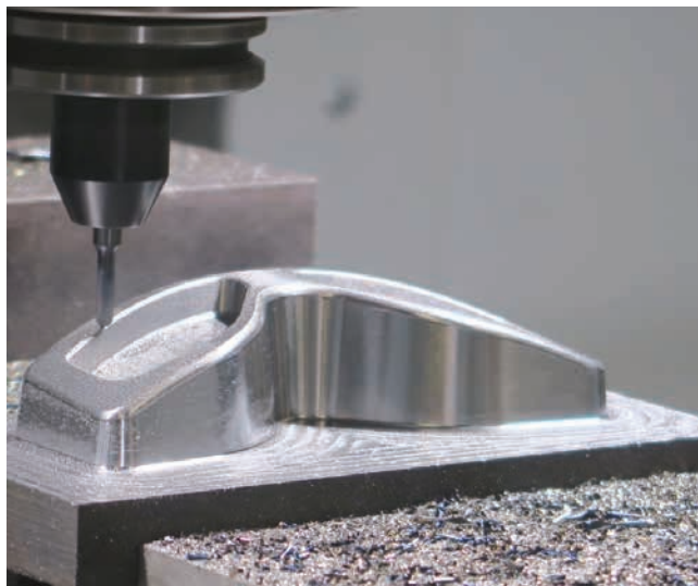
» Slika 6: VHO gravure na stroju Spinner U-1520
