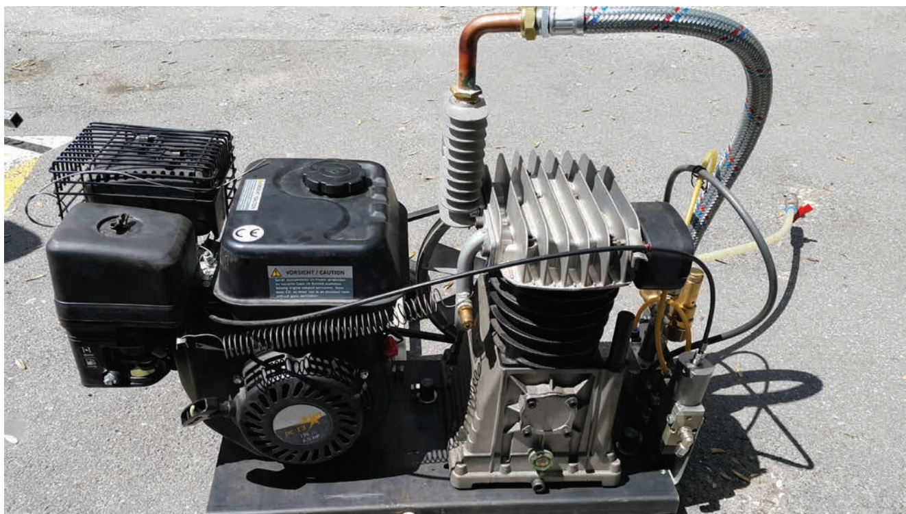
» Slika 2: Enostavno in zelo učinkovito krmiljeni kompresor, gnan z bencinskim motorjem
