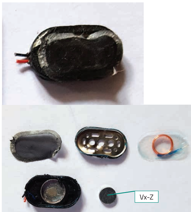
» Slika 3: Vzorec zvočnika – prikaz sestavnih delov zvočnika prenosnega telefona
