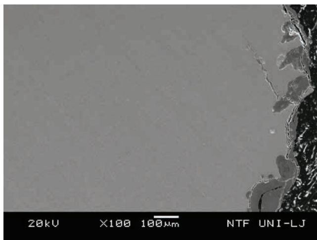
» Slika 5. Osnovni prerez vzmeti čez prelom. Korozijski produkti na površini in prelomni površini vzmeti. Sekundarna razpoka zapolnjena s korozijskimi produkti.
