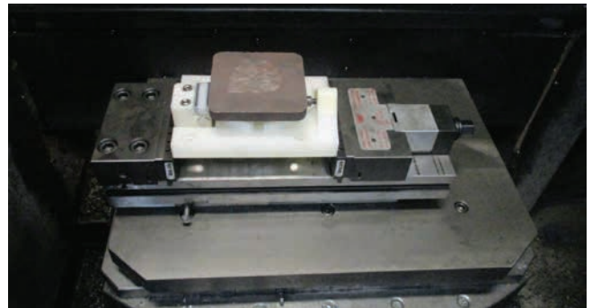
» Slika 4: Primer vpetja priprave ( optimiranje )
