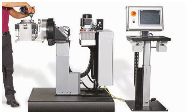
» Desno je komandni modul za posluževanje komponent modulog, s pomočjo katerega se lahko celotni napredek proizvodnje nadzoruje z vsako mobilno napravo, ki ima brskalnik. Poleg njega je montažno delovno mesto zgrajeno iz zaslučnega in dvižnega modula (Slika: ROEMHELD).
