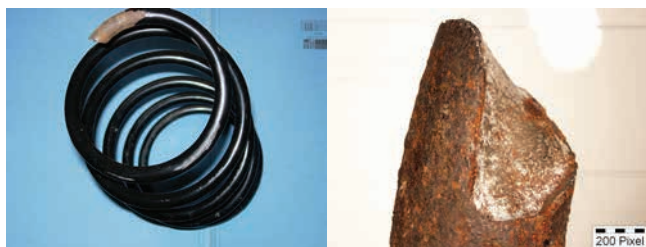
» Slika 1. Poškodovana vijačna vzmet zadnjega amortizerja osebnega avtomobila
