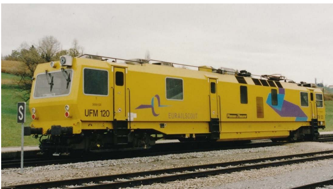
Fotografija 4-47: Merilna drezina Eurailscout UFM 120 na postaji Stranje, oktober 2002
