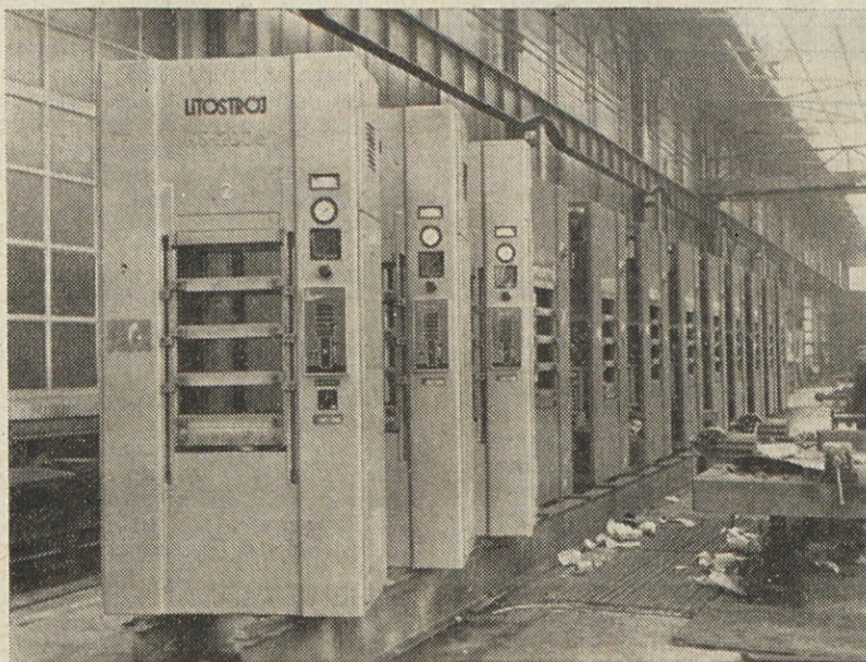
Hidravlične stiskalnice po 200 ton pritiska, kakršnih smo 48 dobavili tovarni RIS v Zagrebu
