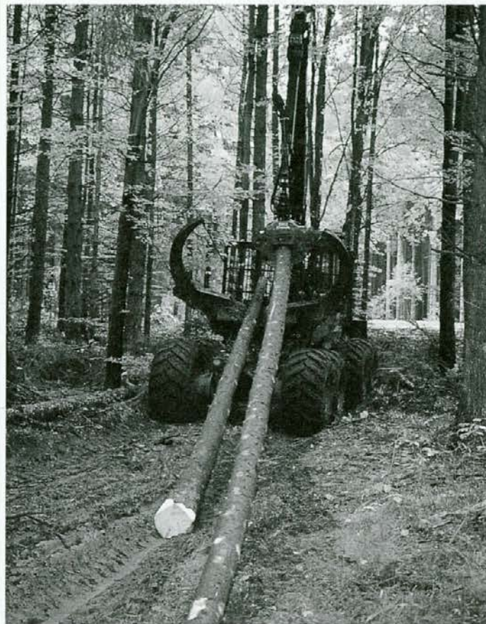
Spravilo celih dreves do ceste s prilagojeno prikolico
