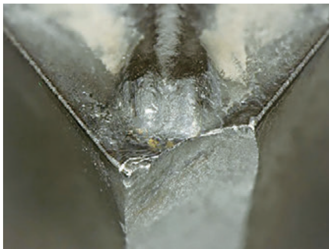
» Slika 5: Poškodba v obliki loma rezilnega roba
