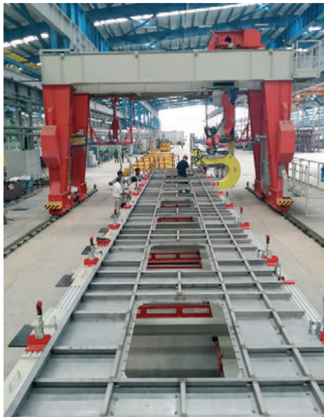
» Slika 8: Varjenec (stena potniškega vagona) ter portal s KUKA manipulatorjem v ozadju
