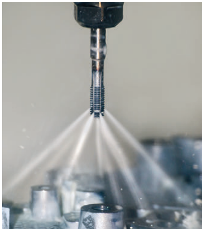
» Walterjev oblikovalec navojev TC430 Supreme omogoča trdnostno močnejše navoje, ki prenesejo večje dinamične obremenitve. Slika: Walter AG
