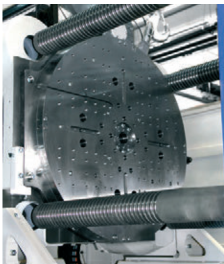
» Vrtljiva miza s servoelektričnim pogonom in premerom 2000 mm.
