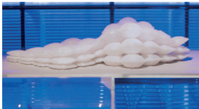
» Tridimenzionalni objekt, ki je zelo dinamičen in oblikuje obliko in funkcijo. Metrski objekt ima robotsko podobno transformacijo iz pnevmatskega sistema s sedmimi neodvisnimi komorami, ki ustvarjajo različne vzorce gibanja. Foto: BMW
