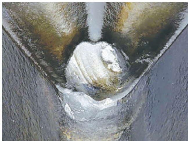
» Slika 3: Značilna obraba v obliki kraterja
