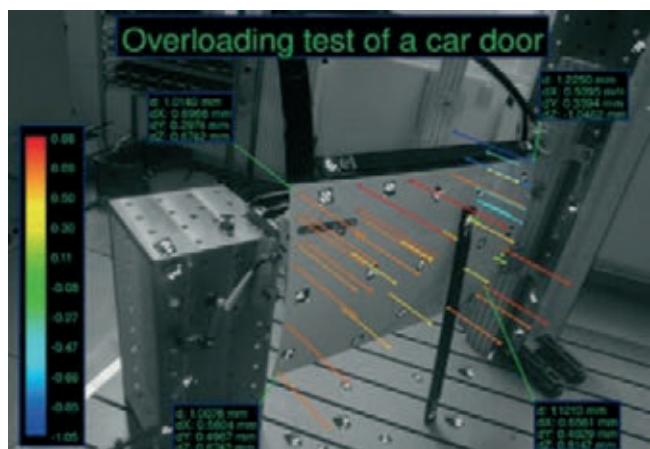
» Slika 2: Pomiki točk na vratih med obremenitvenim testom.
