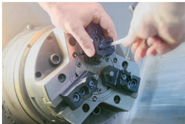
» S pomočjo vložkov za hitro menjavo SCHUNK PRONTO, se razpon vpenjanja običajnih vpenjalnih čeljusti v nekaj sekundah poveča vse do 55 mm, ne da bi bilo potrebno sneti čeljusti.
