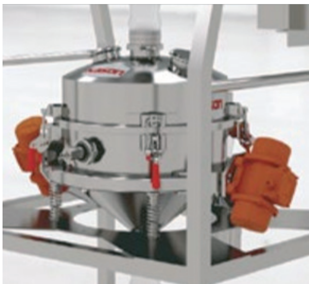
» Sistem 3D-ReKlaimer™ ponuja popolnoma avtomatizirano obnovitev prahu.
