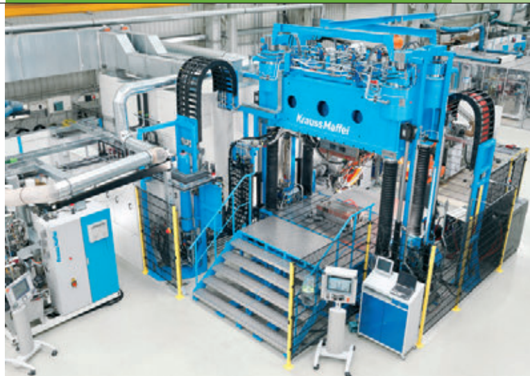
» Slika 8: Sistem »mokrega« stiskanja za izdelavo plastičnih komponent ojačenih z vlakni
