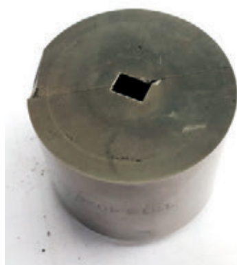
» Tipičen lom orodja zaradi dinamičnega utrujanja materiala.
