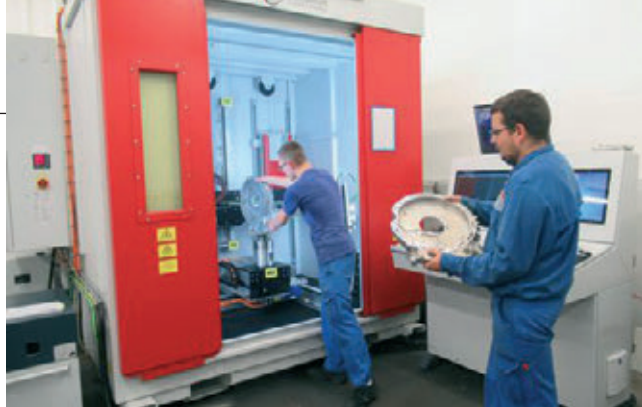
» Nov digitalni rentgenski sistem XRH222 proizvajalca VisiConsult. | Vir: Handtmann, Light Metal Casting
