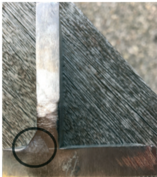
» TIP TIG HDMT Focus: Kotni zvar brez predhodne priprave zvarnega spoja. Debelina pločevine 8 mm + 10 mm.
