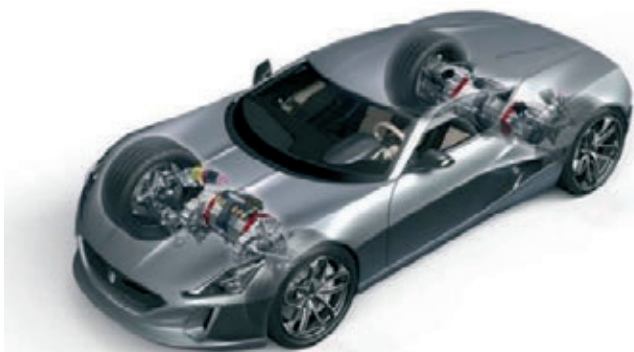
» Slika 2: Rimac Concept One s štirimi motorji, po dva na prednji in zadnji osi [2].
