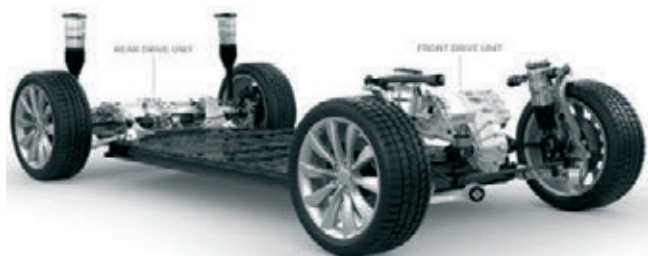
» Slika 1: Pogonski sklop Tesle S z motorjem na prednji in zadnji premi [1].
