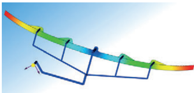
» Slika 4: Simulacija brizganja druge komponente
