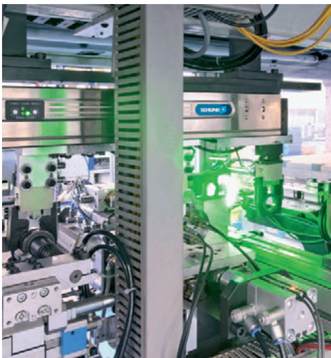
» V tej aplikaciji so bili pnevmatski linearni moduli zamenjani z linearnimi direktno gnanimi linearnimi osmi SCHUNK ELP. Rezultat so močno zmanjšane vibracije, minimalizirana obraba uporabljenih komponent in skrajšan cikel obdelave.
