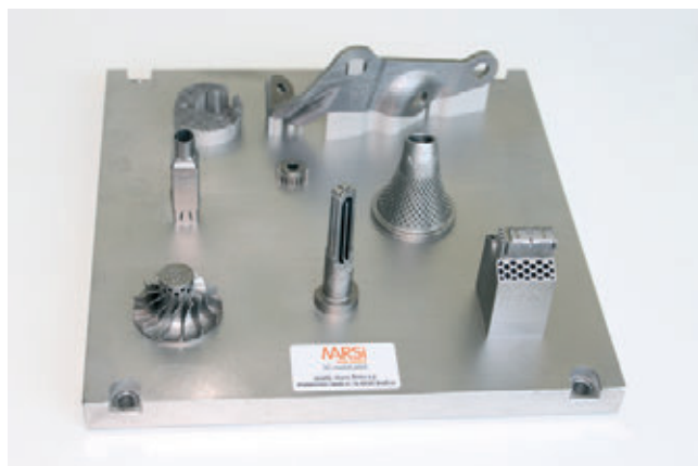
» Slika 3: Primeri izdelkov izdelanih v podjetju MARSİ, Mario Šinko, s. p., s tehnologijo 3D-DMLS.
