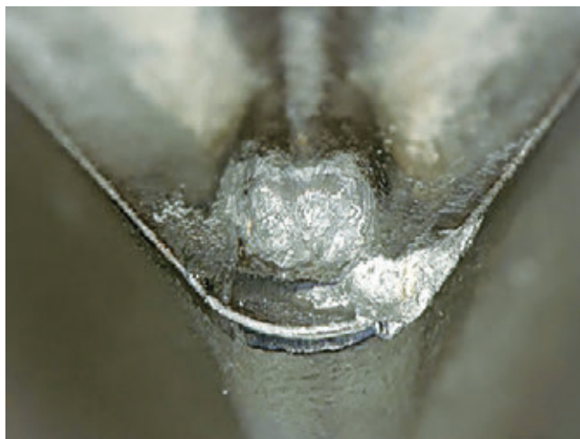
» Slika 4: Značilna obraba rezalnega roba zaradi nalepkov
