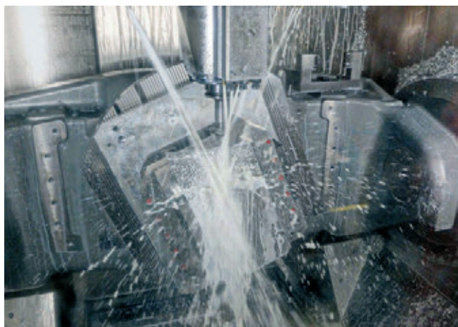
» Delovni volumen 850x700x500 mm pri stroju Hermle C 400, kjer je prikazana rotacijska miza ob uporabi 4. in 5. osi stroja za struženje. Obloge mize so iz nerjavnega jekla. Vir: Geo Kingsbury
