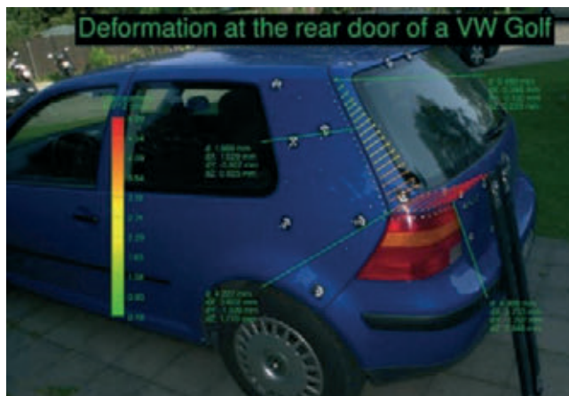
» Slika 4: Deformacija vrat prtljažnega prostora.
