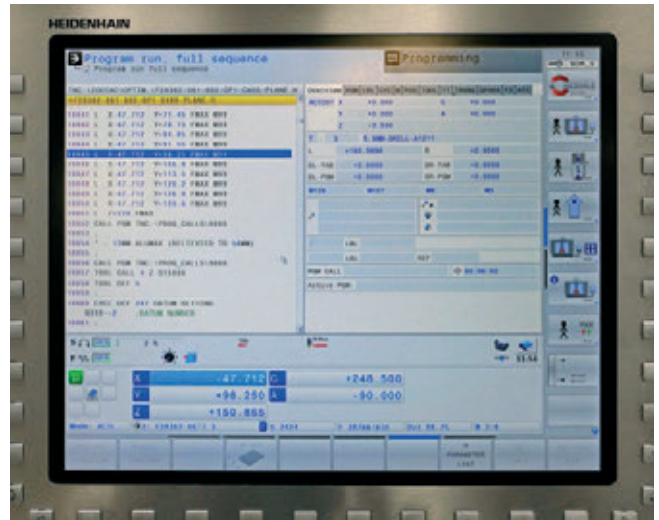
» Hermle C400 uporablja Heidenhainov krmilnik TNC 640, ki je po mnenju operaterjev v podjetju FGP Systems uporabniku prijazen sistem. Vir: Geo Kingsbury
