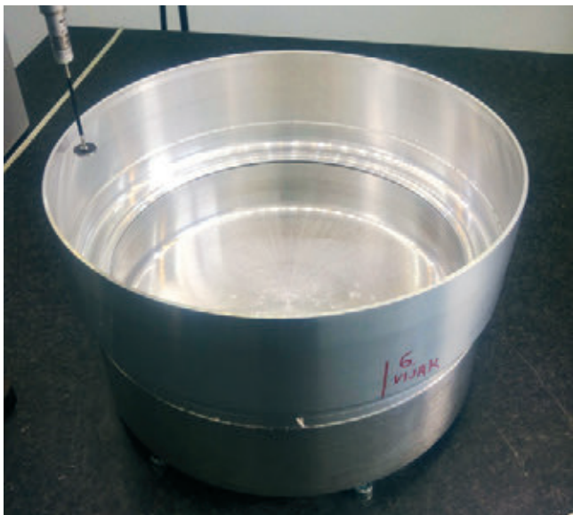
» Slika 8: Meritev cilindričnosti ohišja rotorja v pripravi
