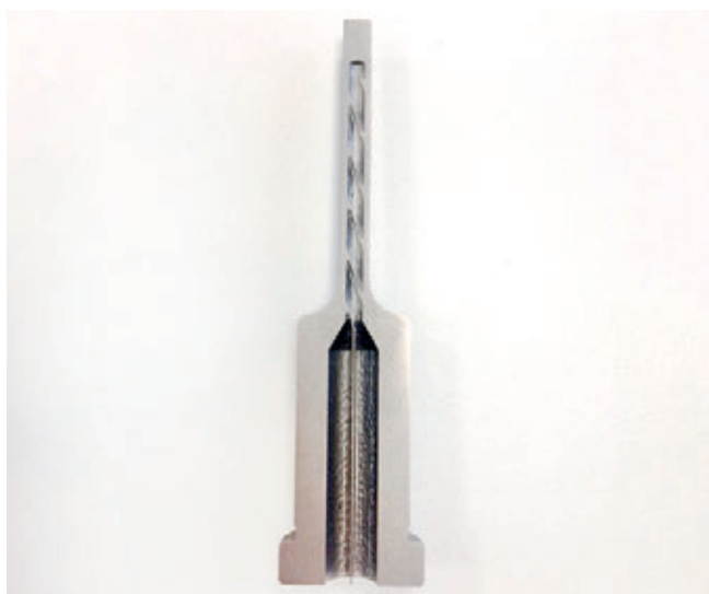
» Slika 1: Jedro orodja s konformnim hlajenjem za brizganje plastičnih komponent.
