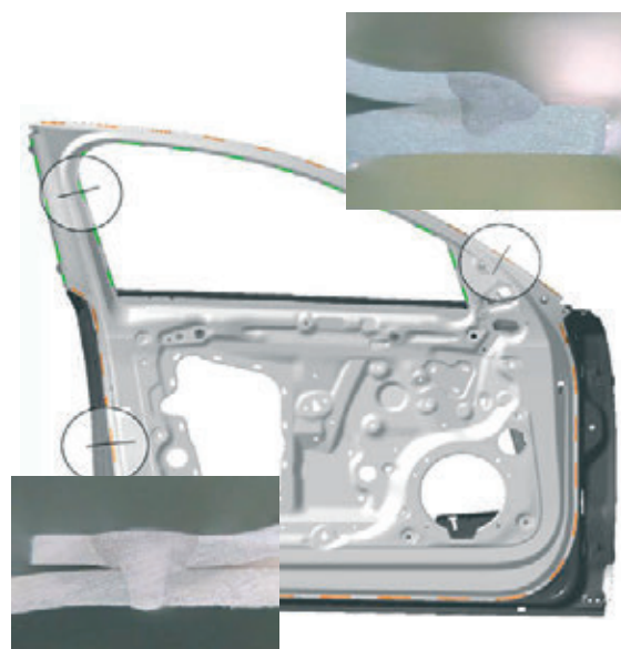
» Slika 8: Primer varjenja vrat za Audi A8, naprava Scansonic ALO3; vir: Latzl. M.: Die leichte und funktionale Tür des neuen Audi A8. Proceedings of Türen und klappen, 2010.
