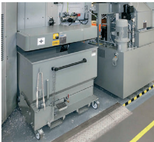
» Širok in nizko vpenjajoč tekoči trak zagotavlja učinkovito odstranjevanje odrezkov na zadnji strani stroja. Vir: Geo Kingsbury
