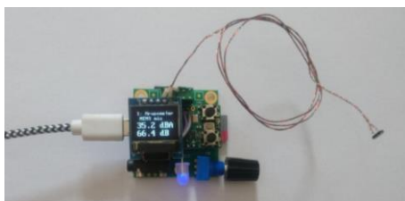
Slika 4. Priključen MEMS mikrofonski preko linijskega vhoda na avdio vmesniku v načinu delovanja 'hrupometer'.
