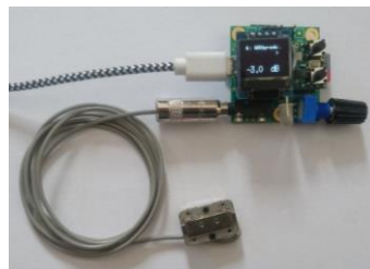
Slika 6. Avdio vmesnik z vibratornim pretvornikom.
