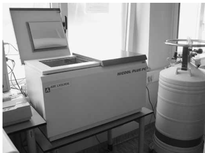
Slika 2: Računalniško voden zamrzovalnik za programirano zamrzovanje s pomočjo tekočega dušika.
