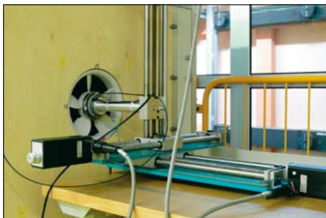
Slika 2. Merilna postaja za merjenje aerodinamske karakteristike aksialnega ventilatorja – a, merilna postaja v odmevnici za merjenje nivoja zvočne moči ventilatorjev – b
