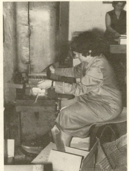
Štancanje pokrovk na 25 tonski štanci v oddelku baterij R 20
