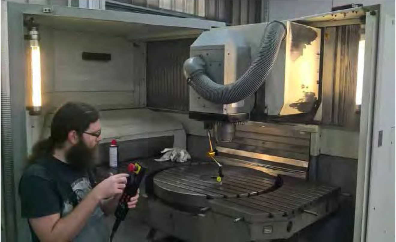
Slika 2 : Mehanske meritve točnosti stroja
