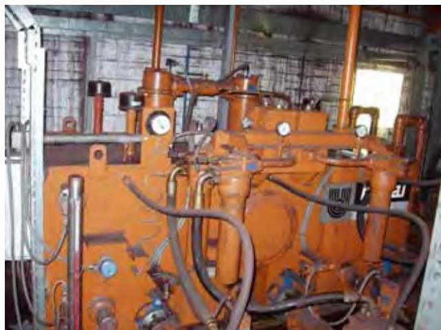
Slika 1 : Hidravlični rezervoar z delom pripadajoče opreme – Vroča valjarna, SIJ Acroni
