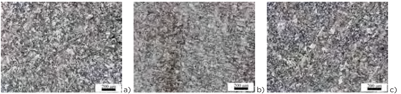
Slika 3 : Mikrostrukture po posamezni fazi topilnega žarjenja pri 50-kratni povečavi: a) 1. faza homogenizacijsko žarjenje, b) 2. faza – zmanjšanje velikosti kristalnih zrn z ogrevanjem, c) 3. faza – raztopno žarjenje
