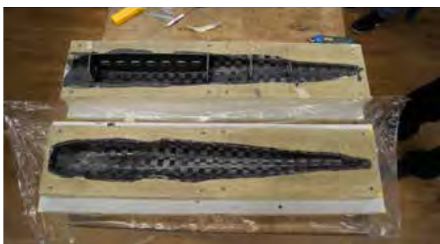
Slika 7 : Kalupi iz purenita, uporabljeni za izdelavo trupa
