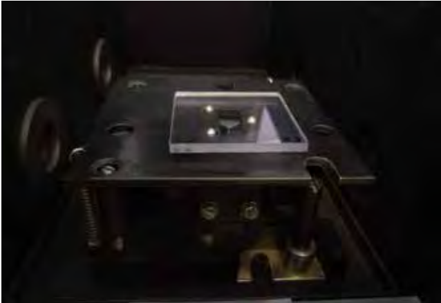
Slika 7 : Namestitvev stekla v spektrofotometer
