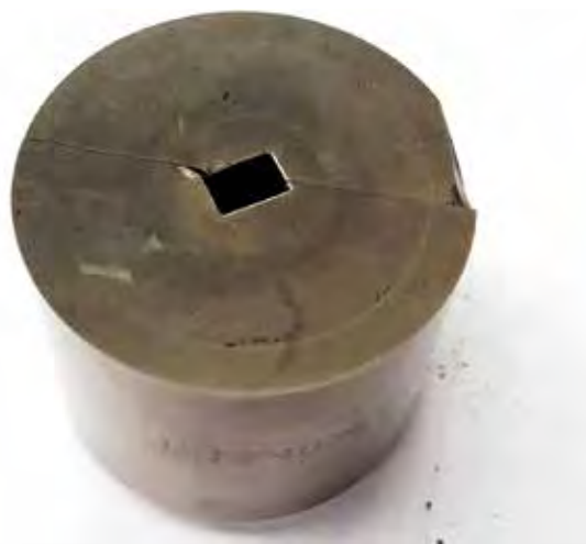
Tipičen lom orodja zaradi dinamičnega utrujanja materiala
