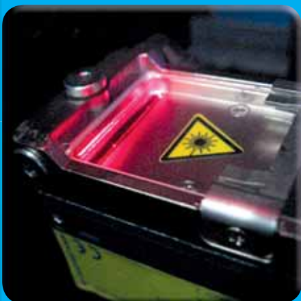
Svetlobno tipalo nadzornega sistema AMS.
