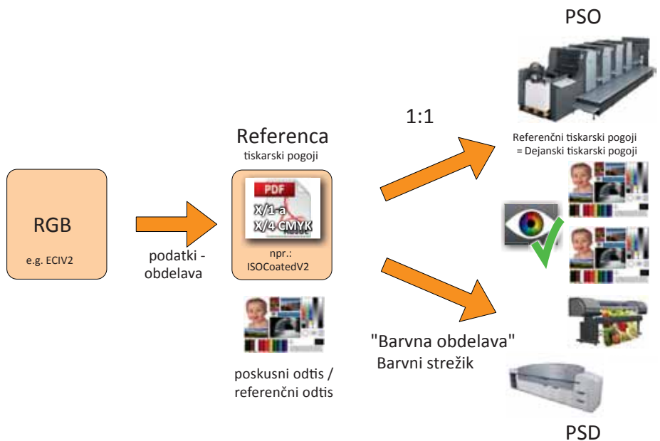
Slika 1: Barvna komunikacija med PSO (ISO 12647-2) in PSD. Referenčne izpise/odtise izdelamo na podlagi predvidenih tiskarskih razmer, ki so definirane v standardu ISO 12647-2. Ti so lahko izpisani na digitalnih tiskarskih sistemih ali pa so korektno upodobljeni na ekranskem predogledu (pogodbena ali primerjalna referenca/odtis - Contract Proof or Validation Print). V primerjavi z dejanskim ofsetnim odtisom gre za referenco v merilu 1 : 1. Če je treba, lahko prilagoditve za korektno skladnost izvajamo na RIP-u (rastrsko procesnem sistemu). Pri izdelavi poskusnega odtisa z digitalnimi tiskarskimi sistemi zaradi pogosto uporabljenih nestandardnih procesnih barv je potrebna ustrezna barvna pretvorba v skladu s simulacijo predvidenega tiska in zagotovitev čistosti simuliranih procesnih barv.
