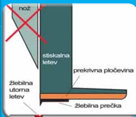
Enostaven namestitve žlebilnih komponent rezalnik v trenutku spremeni v sistem za žlebljenje.
