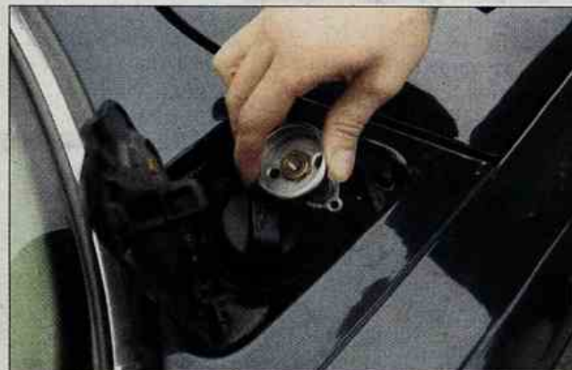
Ob običajnem pokrovu imajo lastniki vozil na avtoplin vgrajen dodaten nastavek za plin.
