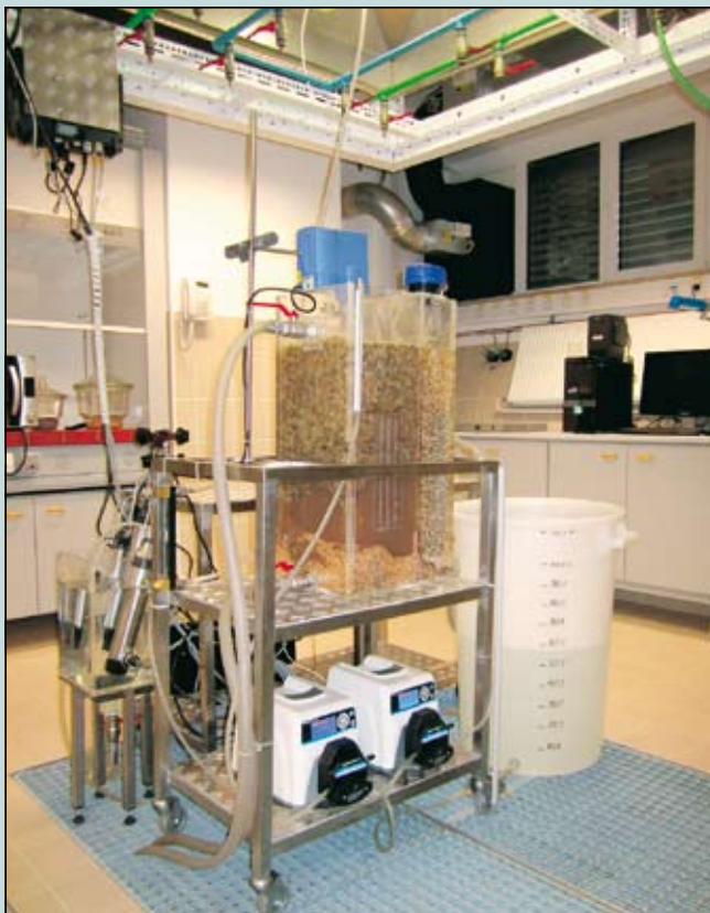
Hibridni membranski biološki reaktor za čiščenje pitne vode, onesnažene z nitratnimi ioni
