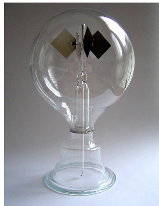
Slika 35.11 Svetlobni mlin. Lopatičasto kolo je vrtljivo okrog navpične osi v izsesani posodi. Lopatice so na eni strani črne, na drugi zrcalne. Ko na kolo sije svetloba, se vrti. (Anon)
