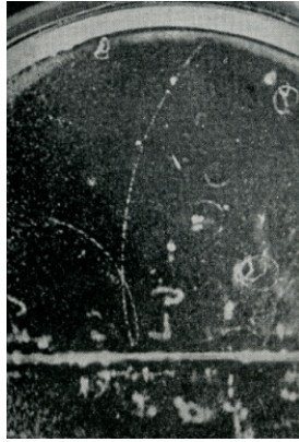
Slika 44.23 Nastanek para elektron - pozitron ob vpadu fotona gama z energijo 5,7 MeV na svinčeno ploščo z debelino 0,5 mm. (Anon)
