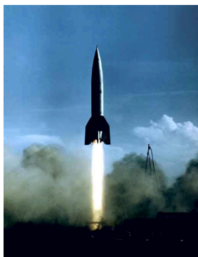
Slika 34.3 Izstrelitev rakete. Prikazana je ena izmed raket, razvitih med drugo svetovno vojno. Končna hitrost rakete je odvisna od deleža pokurjenega goriva in hitrosti izpuha. (NASA History Office)
