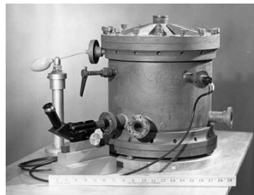
Slika 39.9 Merjenje osnovnega naboja na kapljicah v električnem polju ploščatega kondenzatorja. Prikazana je priprava, ki jo je zgradil in uporabil A. Millikan. (University of Chicago)
