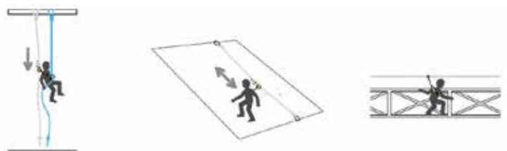
Slika 3: Sistemi za prestrežanje padca na različnih gradbenih konstrukcijah [vir: Petzl, 2013].
