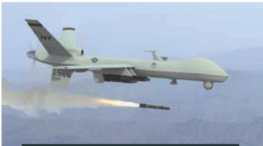
General Atomics MQ-1 Predator je vrsta brezpilotnega letala, ki je opravila večino ameriških napadov v vojnah v Afganistanu in Pakistanu.
