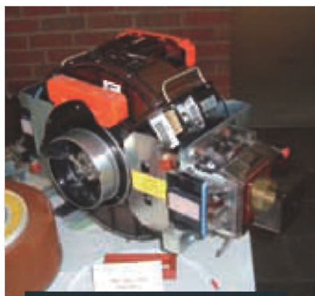
Izmenljivi diskovni modul IBM 3380 z zmogljivostjo 1 GB
