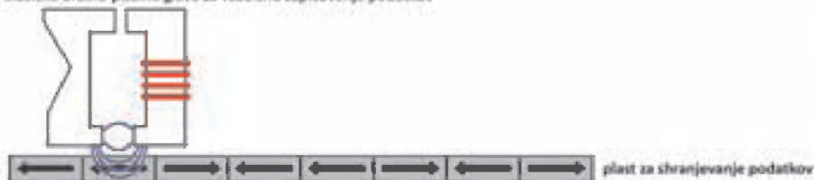
klasična bralno-pisalna glava za vzdolžno zapisovanje podatkov
