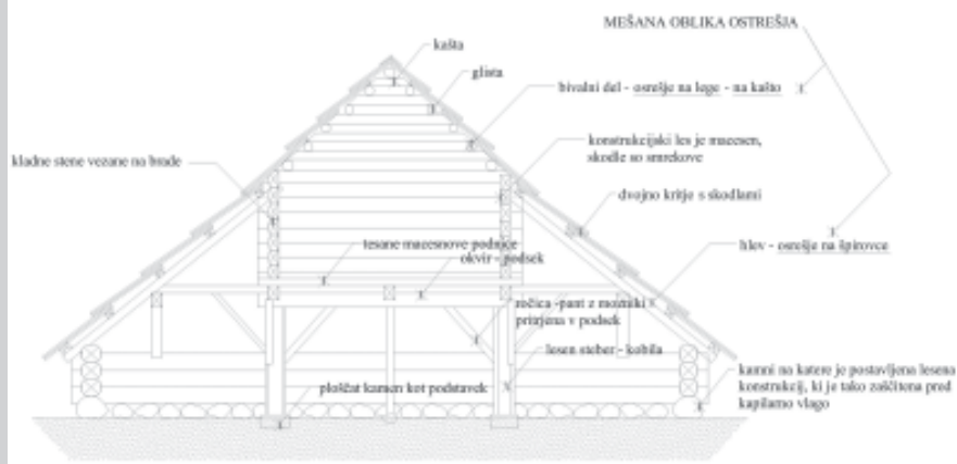
□ Slika 5. Terminologija konstrukcije stanu na kobilah
