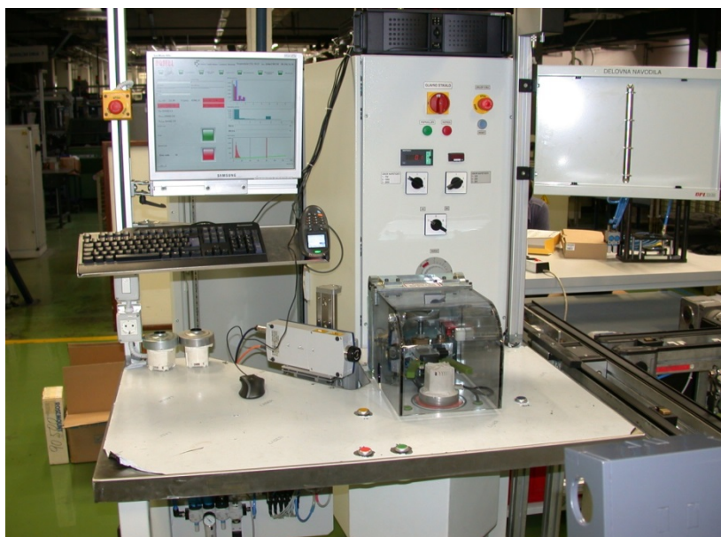
Diagnostični sistem za končno kontrolo elektromotorjev na novi proizvodni liniji eko-motorjev v Domel-u
