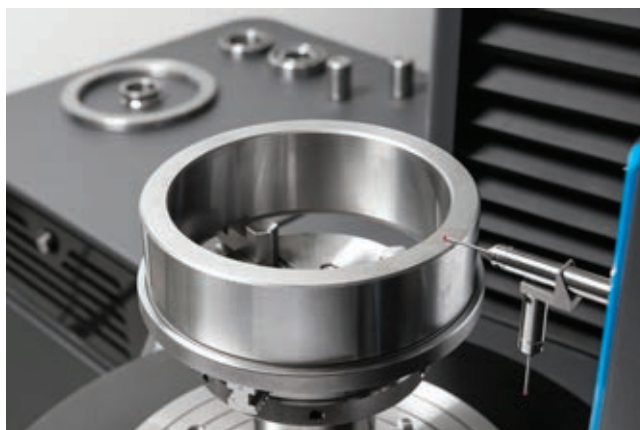
» Merjenje kotalnega ležaja z natančnim merilnim centrom različice G podjetja Klingelberg. | Vir: Klingelberg
