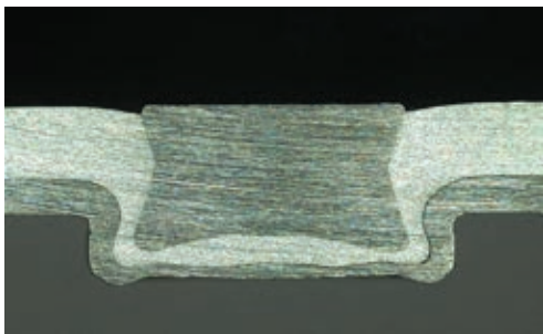
» Posnetek obruska spoja ClinchNiet®
