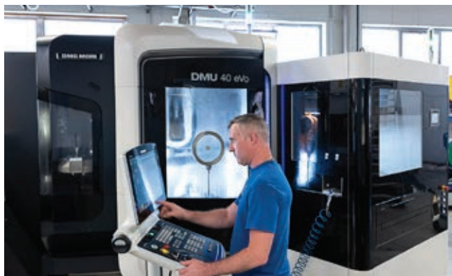
» Obdelovalni stroj DMU 40 eVo s sistemom za manipulacijo obdelovancev WH 8 CELL: avtomatiziran postopek freziranja povečuje razpoložljivost stroja, zmanjšuje stroške napak in povečuje splošno produktivnost.
