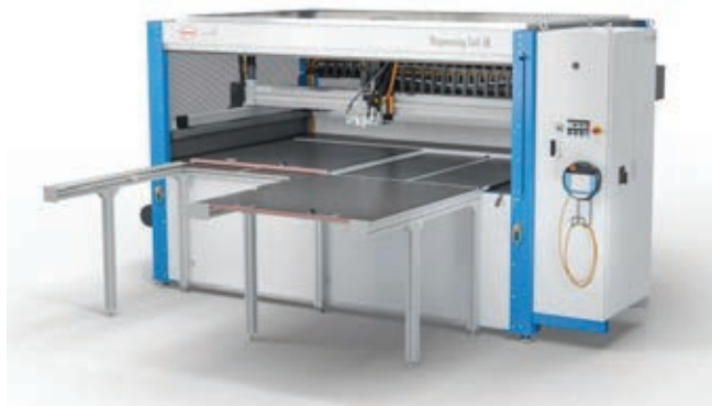
» Nova celica za nanašanje dvokomponentnega tesnila in lepila 3E podjetja Sonderhoff omogoča takojšnjo uporabo po namestitvi | Vir: Sonderhoff Holding
