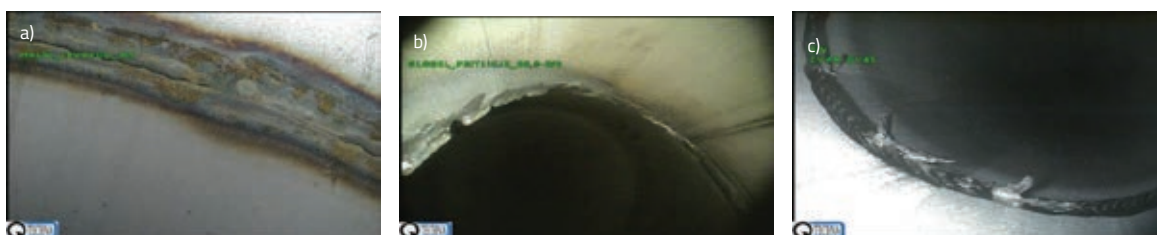
» Slika 6: Primeri iz prakse a) Neprimeren obarvanost v korenu; b) Vključki; c) Neenakomeren koren zvara
