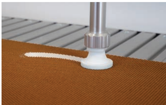
» Nanašanje dvokomponentnega polnila podjetja Huntsman z mešalnikom vipro-DUOMIX podjetja ViscoTec. | Vir: ViscoTec Pumpen- u. Dosiertechnik
