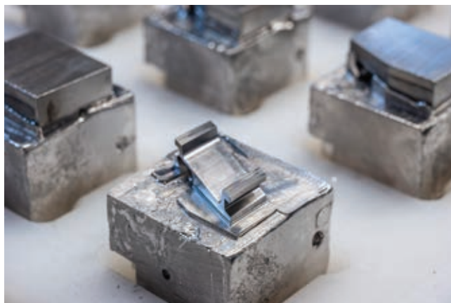
» Ta projekt se nanaša na avtomatizirano proizvodnjo zgornjega in spodnjega dela geometrije različnih vodilnih lopatic za kompresorje motorjev. Površine lopatic so izdelane v ločenem postopku in so obdane s pretaljenim materialom za zaščito in kakovostnejše vpenjanje.
