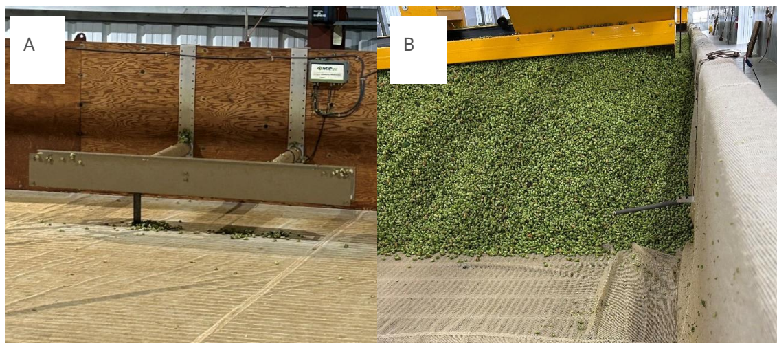
Slika 2: Merilne sonde za merjenje vlage v hmelju in temperature sušenja (Foto: I. J. Košir)
