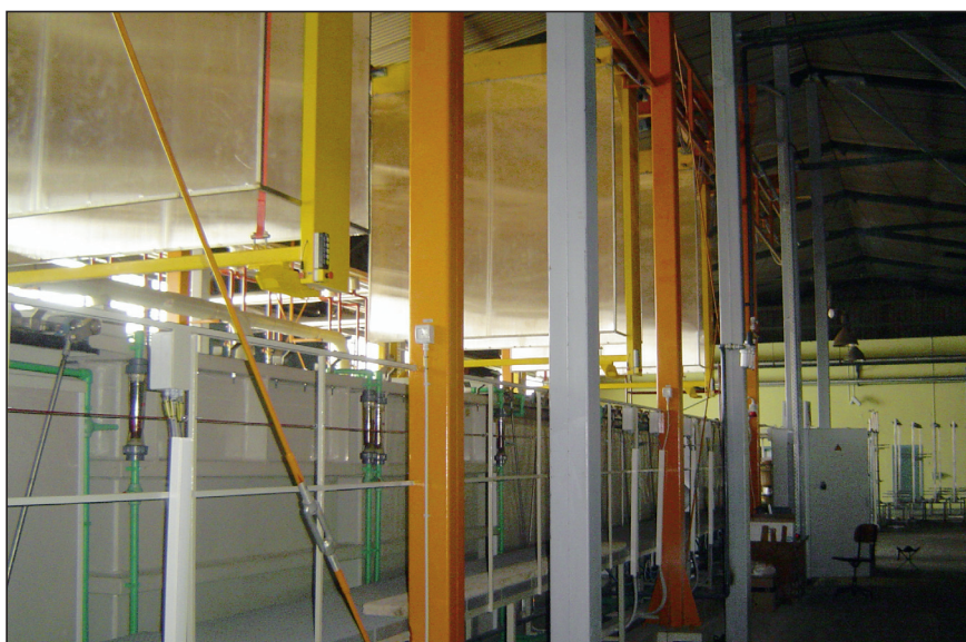
Predobdelava bojlerjev, galvana
