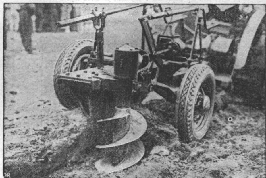
NOVODOBEN PLUG — V Švici vpeljajo v poljedelstvo takle ogromen sveder, ki bolje obrne, zrahlja in prezrača zemljo kakor navadni plug.
