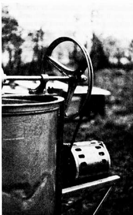
Električno točilo kmalu tudi pri nas ne bo več redkost. Danes si nekateri pomagajo kar z elektromotorji iz odsluženih pralnih strojev. (Izdelava Oto Primožič — Prebold)
