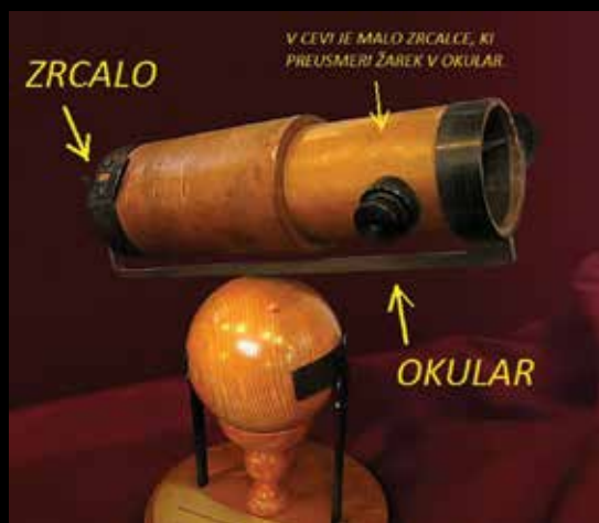
Replika Newtonovega teleskopa - reflektorja iz leta 1672.
