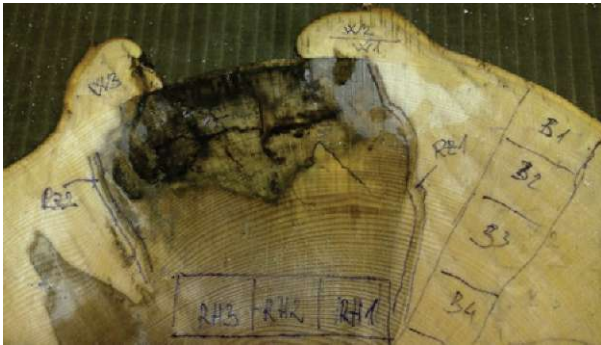
Slika 4. Topografija tkiv na prečnem prerezu poškodovanega dela debla bukve. B = vzorci beljave, W = poranitveni les, RH = vzorci rdečega srca, RZ = reakcijska cona. odvzeli smo tudi vzorec razkrojenega lesa in ga označili z D, vendar oznaka na sliki ni razločna.
