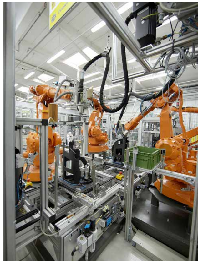
› Del linije za robotizirano montažo žarometov
