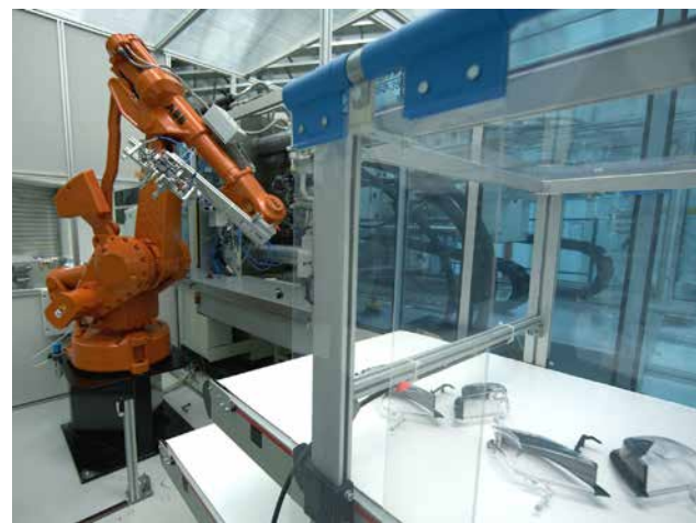
➤ Odvzem izdelkov iz stroja za injekcijsko brizganje termoplastov
