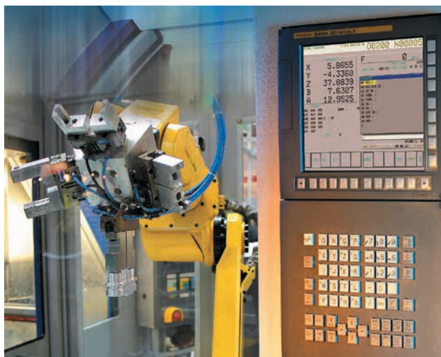
» CNC-krmilja FANUC omogočajo enostavno integracijo robota Fanuc z obdelovalnim strojem
