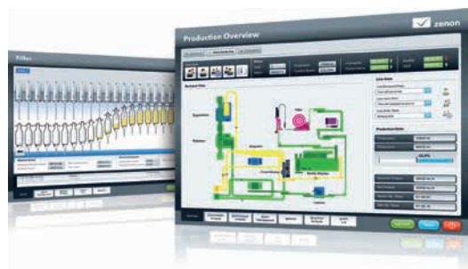
» Obširen nadzor procesov ter samodejni preračun in prikaz ključnih kazalnikov poslovanja (OEE).
