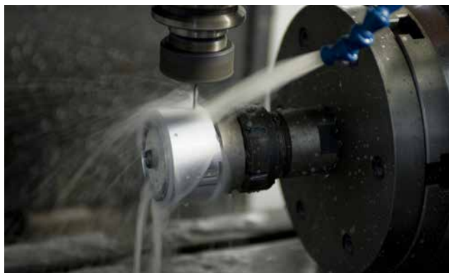
› Mnogi obdelovalni centri Haas pri Appasamyju so opremljeni z vrtljivimi mizami Haas s četrto in peto osjo.
