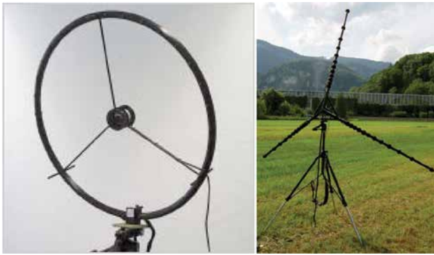
► Slika 3: Mreže mikrofonom – obroč za manjše razdalje in višje frekvenčno območje, križ za večje razdalje in nižje frekvenčno območje
