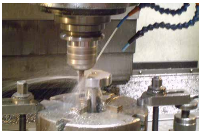
› Slika 4: Režkar, opláčen s TiAlSiN
