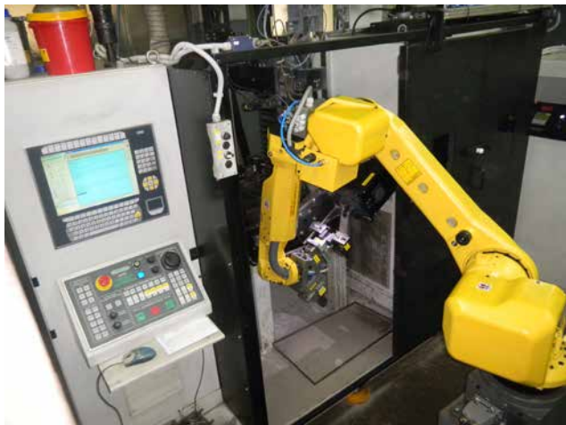
› Robot FANUC AM-120iC izpolnjuje vse zahteve za posluževanje na liniji za navarjanje.
