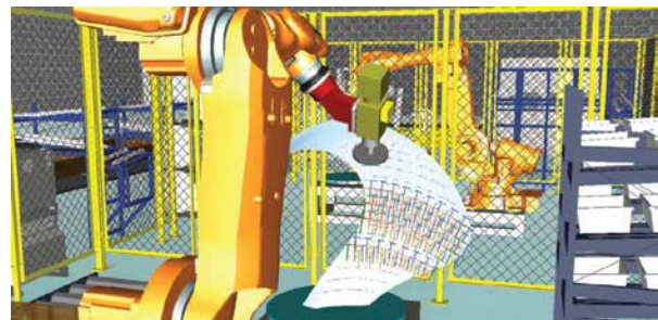
» Simulacija poliranja lopatice s programom RobotExpert
