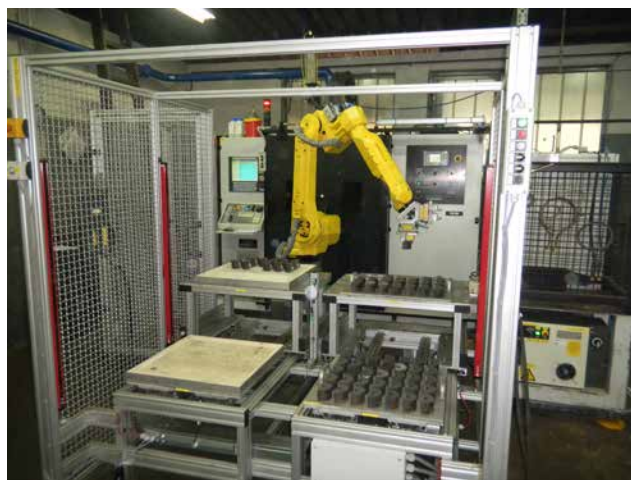
› Izmenljive mize s pnevmatskim pogonom za transport izdelkov v robotsko celico in iz nje.
