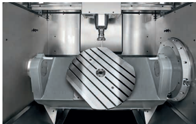
› NC-vrtljiva/nagibna miza z veliko ploščo je integrirana v posteljo stroja.
