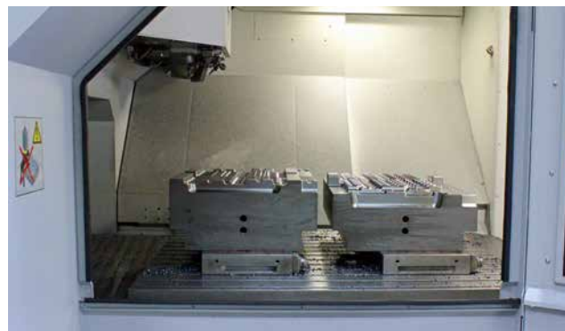
»Velika miza stroja lahko sprejme dva običajna obdelovanca, ki ju je treba približno namestiti na magnetno mizo. Stroj nato hitro preveri njun položaj in začne obdelavo.
