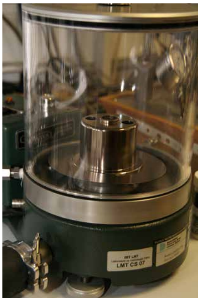
› Vakuumski pokrov pri zračni tlačni tehnici omogoča kalibracije merilnikov tlaka, kot so na primer barometri.
