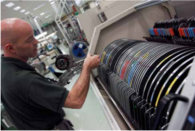
» Predpriprava materiala za avtomatizirano sestavljanje poteka po metodi SMED, ki zagotavlja hitro menjavo in nastavitev stroja ter s tem učinkovito izdelavo manjših serij.
