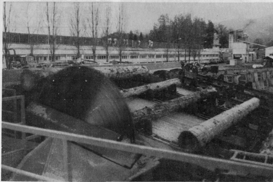
Še zadnje čeljenje in oblovinu potuje po vzdolžnem transporterju, kjer jo automatika po programu odmetuje v odgovarjajoče bokse
