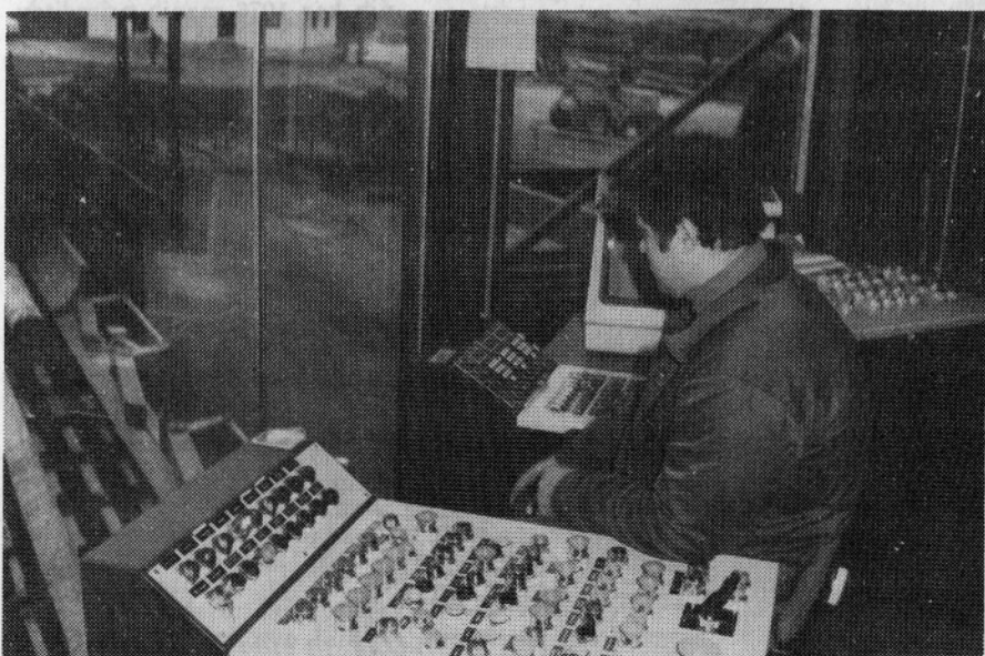
Elektronsko upravljanje mehaniziranega skladišča oblovine; na tem mestu so tudi zabeležbe količin hlodovine, sortirane za LIP posebej
