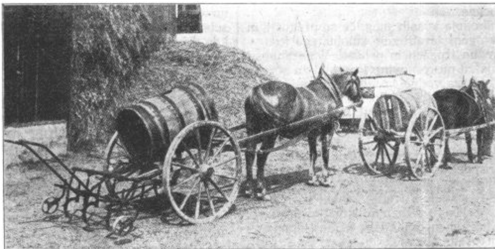
Sl. 33. Gnojnični sod z dvokolnico in pripravo za razdelitev gnojnice v vrste.
