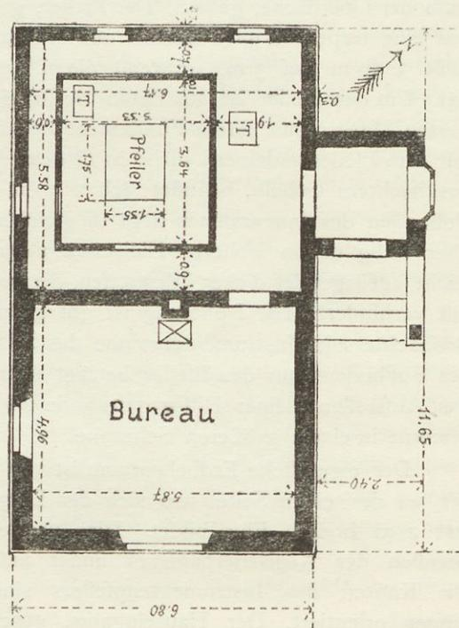
zuschlagen erzeugt einen kleinen senkrechten Strich von etwa 1 mm Länge, was einer Bodenbewegung von  $5\mu$  entspricht. Bei einem stärkeren Besuche von mehr als 50 Personen, die sich allerdings nur in dem äußeren Korridor aufhielten, wurde nur eine geringe Nullpunktsverlegung bemerkt, entsprechend der starken einseitigen Belastung des Hausfundamentes auf der NE.-Seite (dem Eingang).
