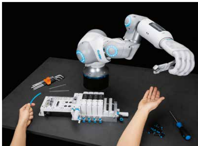
Bionska roka BionicSoftHand deluje pnevmatsko, kar omogoča varno in neposredno interakcijo z ljudmi. (Foto: Festo AG & Co. KG)
