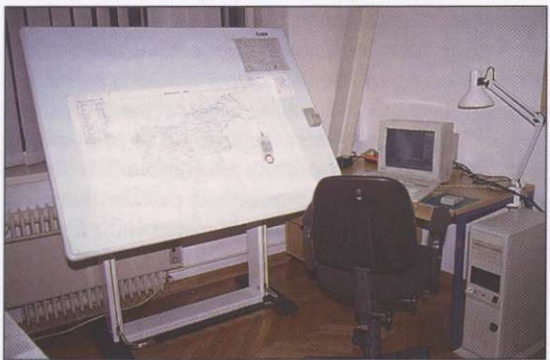
Slika 2: Linijski digitalnik formata A0 na Geografskem inštitutu ZRC SAZU, namenjen vektorski digitalizaciji.
