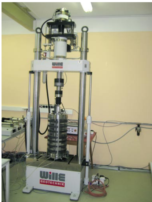
Slika 2 • Torzijski triosni aparat za votle vzorce na ZAG
