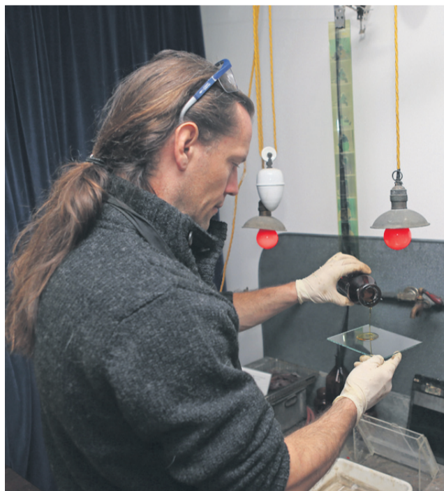
Potem ko Peterlin pripravi stekleno ploščo, se vrne v atelje in jo za šest sekund osvetli. Kar je tudi razlog, da so nasmehi na arhaičnih fotografijah neizraziti oziroma večinoma kar kisli.
