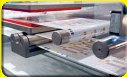
Primer tiska elektronike na tiskovno podlago s posebnimi prevodnimi barvili iz zvitka v zvitek.
