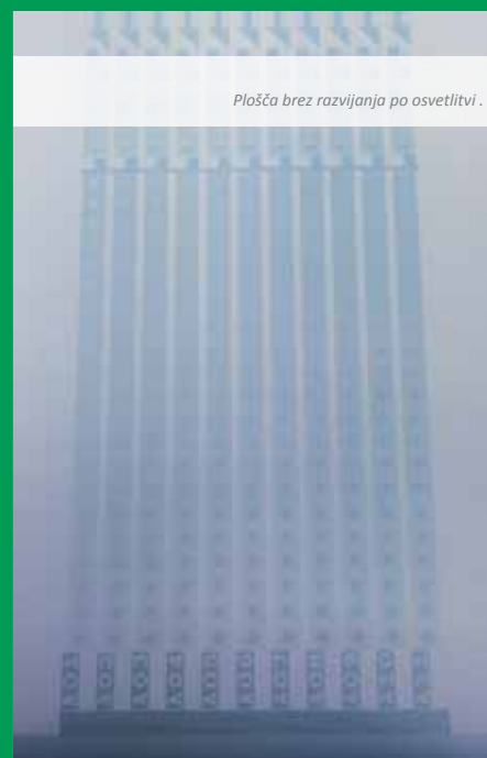
Razvita plošča po tisku brez klasičnega postopka razvijanja s kemikalijami.
